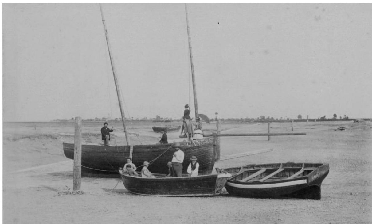
Au port du Vivier la bisquine la Vierge CAN389 Construite en 1876 à Landriais sur la Rance par le charpentier Hily pour son utilité à son lancement suivant la douane le bateau a 1 mât est de type verrot [?] sans pont 6,04m 2,37m 0,99 m 2,75 tx
