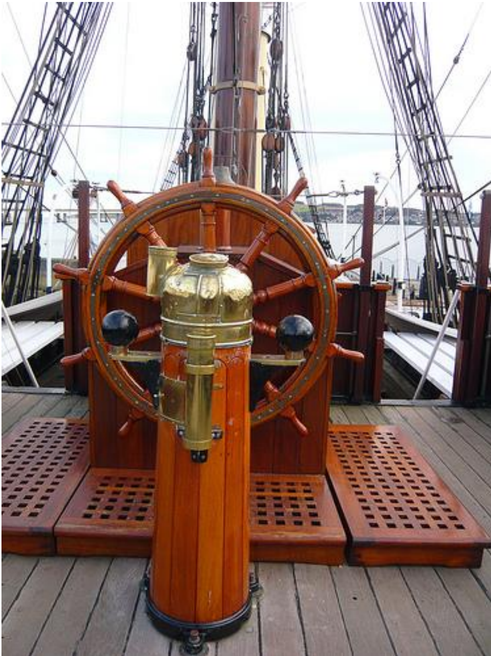
Habitacle du compas de route de type Thomson avec ses globes de fer doux et la barre de Flinders sur l'avant pour la compensation
