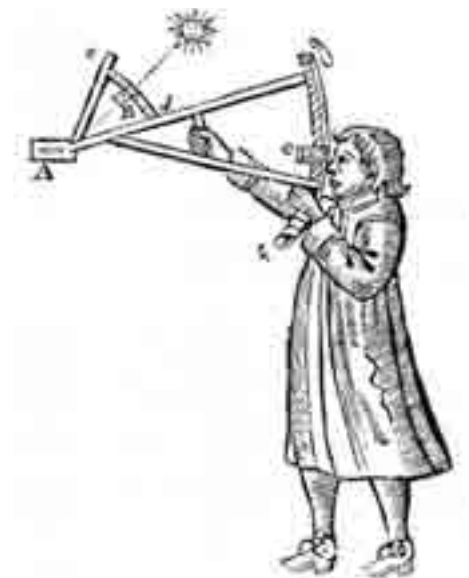
Fig. 110. Utilisation d'un quartier de Davis (D. Mac Intyre, The adventure of sail 1520-1914 , Londres, 1970, fig. 10).
