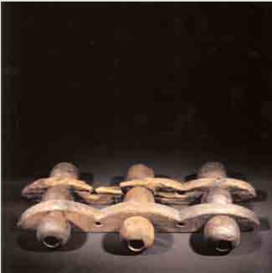
Les éléments du collier de racage F 28
