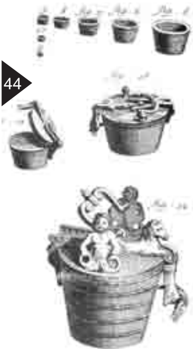
Figure 31. Dessins de piles à godet. Extrait de la planche IV de l'article "Balancier". Encyclopédie Diderot d'Alembert.
