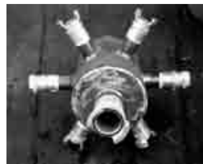
Satellite distributeur immergé permettant d'alimenter six suceuses.
