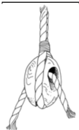
Fig. 24. Schéma d'utilisation d'une poulie à moque
