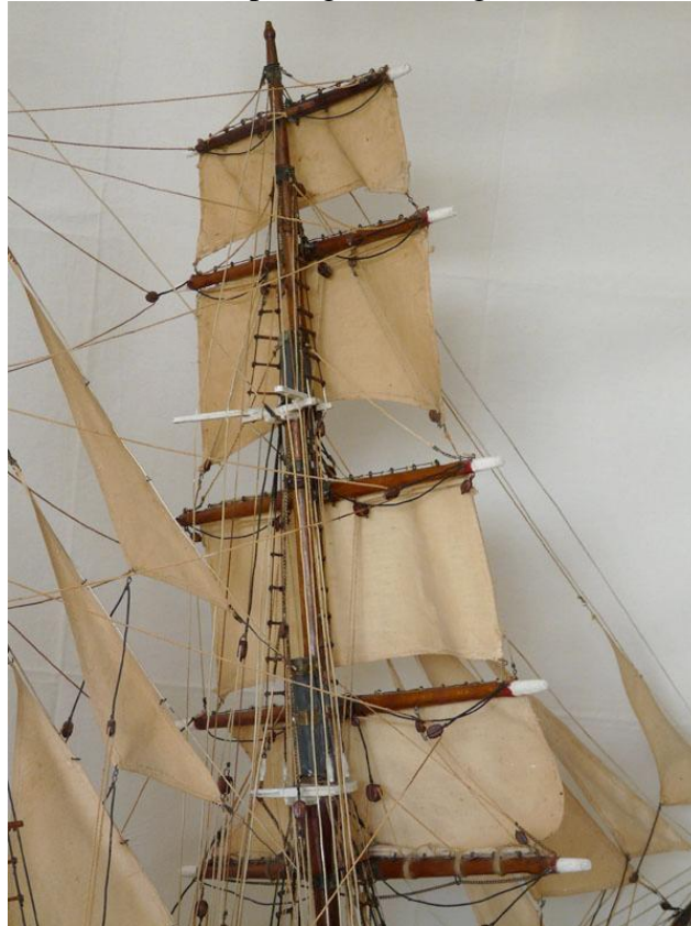
Le grément après restauration, le phare de misaine comprend, misaine, hunier fixe, hunier volant, perroquet et cacatois
