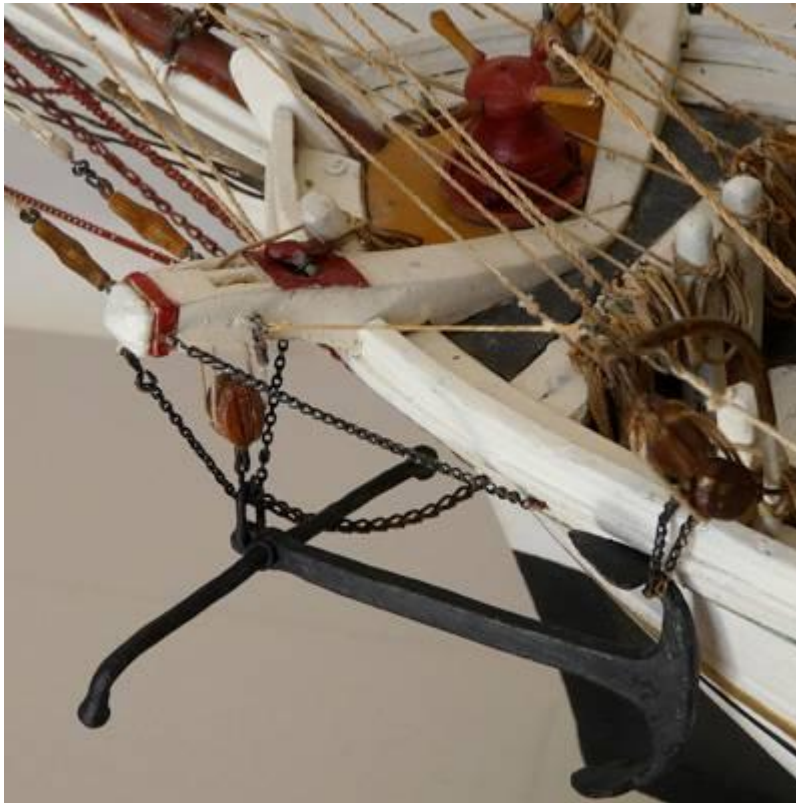
Le crochet plat sur le dessus du bossoir sert de clavette de mouilleur
