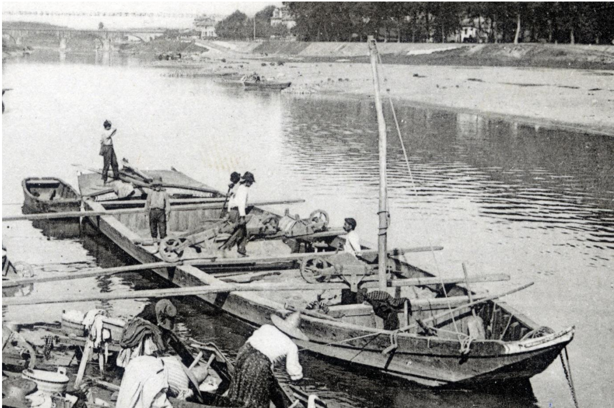
Dans le port de Dax, une galupe est en déchargement à proximité immédiate des lavandières. On distingue nettement, sur l'avant, le mât de chirgue destiné au halage.
