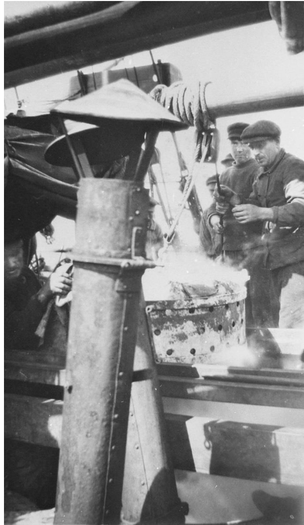
« la corbeille est dégagée de l'autoclave et posée sur des traverses de bois formant rail pour permettre de la glisser sous une toile pour le refroidissement du poisson »
