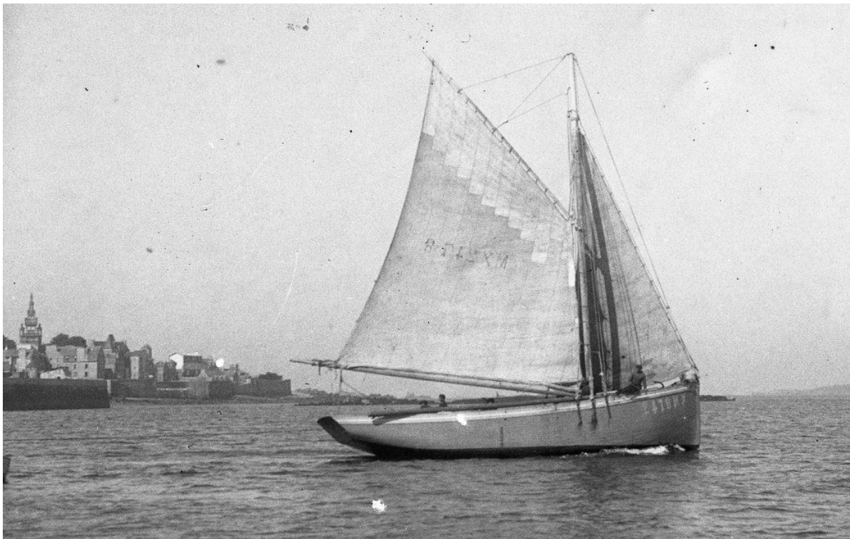
L'Ariel II Mx 2478 à Esprit le Mat sortant de Roscoff naviguant sous grand-voile à deux ris et trinquette son long bout dehors est rangé sur la lisse tribord (Coll perso)
