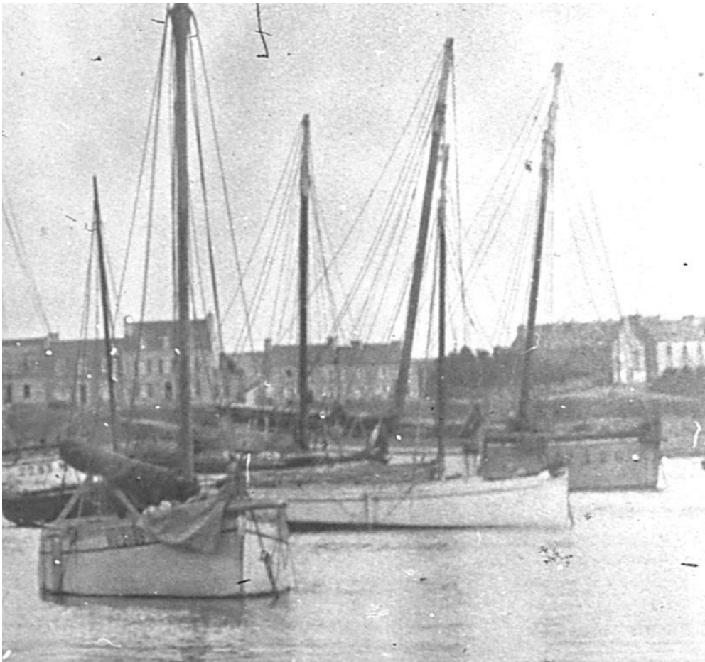
Été 1932, sur la droite en arrière-plan le Louis-Madeleine Mx2426 avec son bout dehors rentré passant dans un trou du pavois (coll perso)
